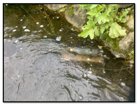
FIGURE 5-8. SONDE DEPLOYMENT DOWNSTREAM OF BETHANY DRIVE.
